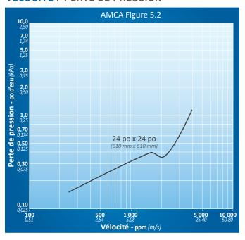
Les essais de perte de pression ont été effectués selon le standard 500-D de l'ANSI/AMCA, Figure 5.2. Le volet testé est installé verticalement et est situé à l'extrémité d'un conduit d'une longueur égale à 5 fois son diamètre, avec une sortie dans une zone libre. Le conduit et le volet sont situés en aval de l'alimentation d'air.
