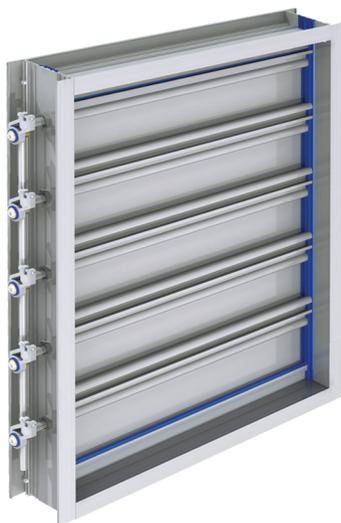
Les volets anti-retour pour applications robustes de TAMCO sont fabriqués de pièces solides afin de résister à la pression statique et aux vitesses élevées. Les lames sont conçues avec une tête ronde, réduisant ainsi la perte de pression. La Série 7600 est fabriquée avec les mêmes systèmes de coussinets à double scellage et de tringlerie antidérapante que ceux des volets de contrôle TAMCO, leur attribuant ainsi un rendement fiable, uniforme et sans entretien.
