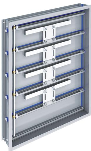
Les volets anti-retour avec contrepoids pour applications semi-robustes de la Série 7000 CW de TAMCO sont complètement ajustables sur le chantier et peuvent être réglés pour un délestage de la pression d'air différentielle moindre que 0,01 po d'eau (3,0 Pa). Les contrepoids sont filetés et permettent facilement les ajustements sur place.
