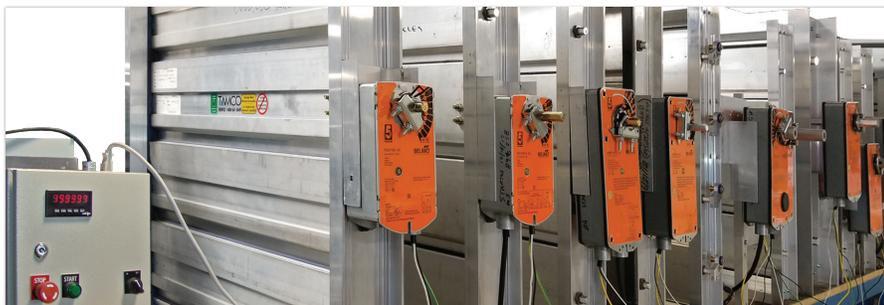
Les actionneurs installés sur chaque volet étaient raccordés à un dispositif électronique de mesure de cycles chronométrés.
