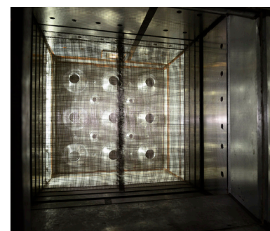
Buses et écrans / appareil de décantation
