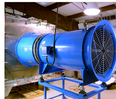
Ventilateur connecté à une chambre d'étanchéité
