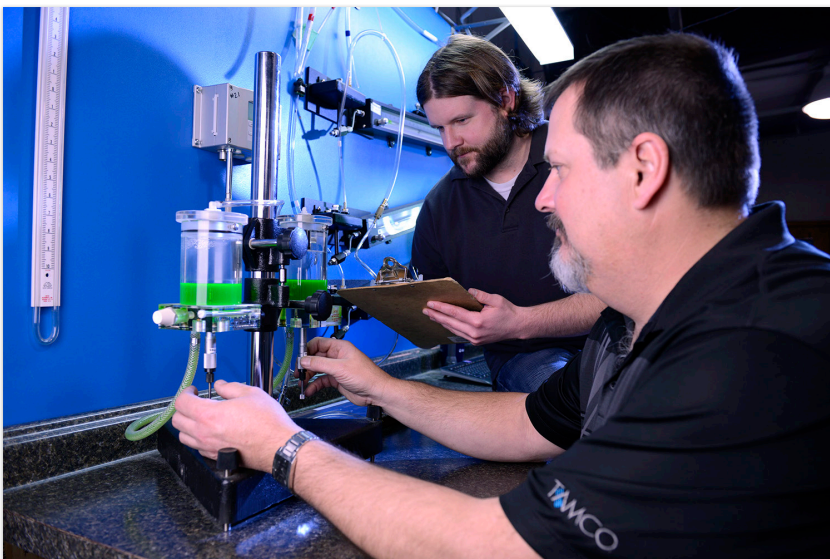
Vérification de la calibration, du fonctionnement et de la précision du manomètre
