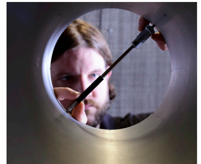
Mesure des buses afin de vérifier leur parfaite rondeur
