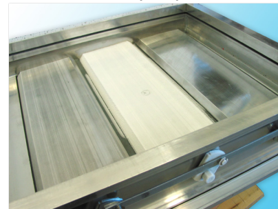
Volet avec barrière thermique sur glace sèche.
