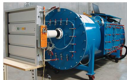
*Chambre d'essai d'étanchéité de TAMCO*
